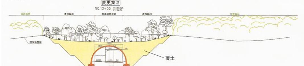
既定計画で南北連絡道路は、樹林地を掘削改変して造成する平面道路でしたが、対策検討を繰り返す中で地形条件を活かし造成量を減らした半地下構造とし、上部に土を盛って元の樹林を再生する構造としました。
